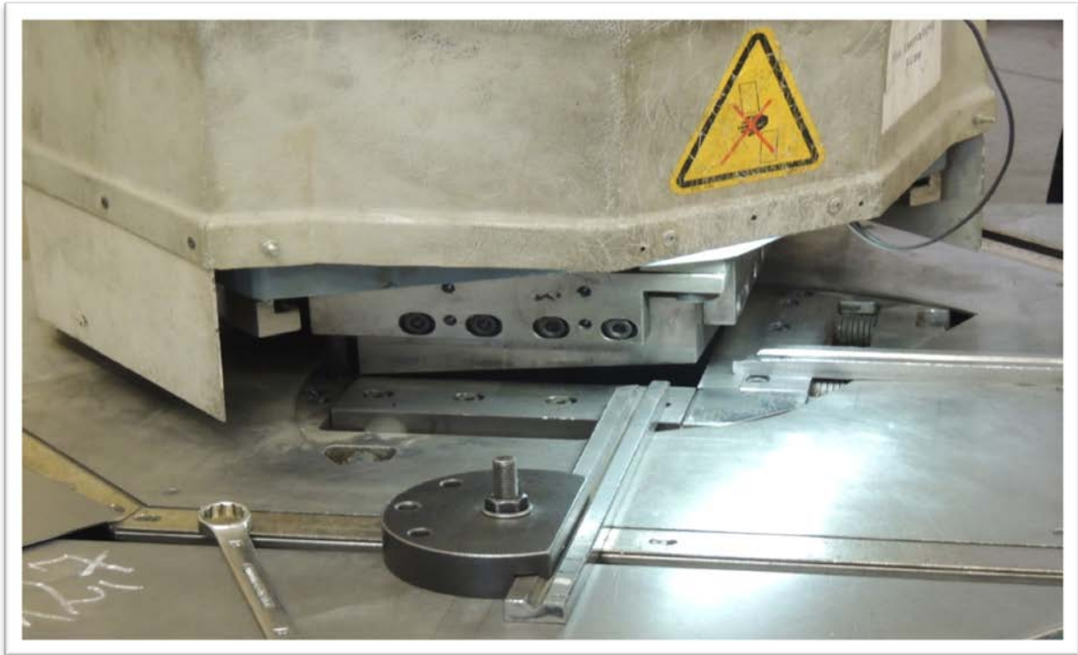
Leszerelt védőburkolat egy sarokkicsípő sajtológépen. > Helyes gyakorlat: A védőburkolatot vissza kell szerelni, illetve helyezni!
