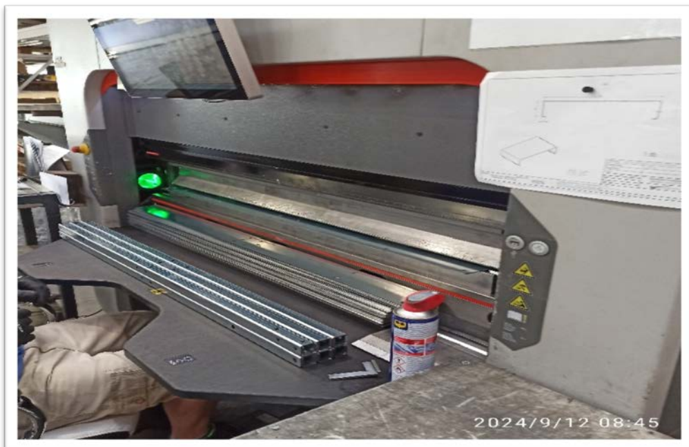
A gépkezelő veszélyes térbe való benyúlását megakadályozó aktív optoelektronikus védőberendezéssel ellátott élhajlító berendezés.
