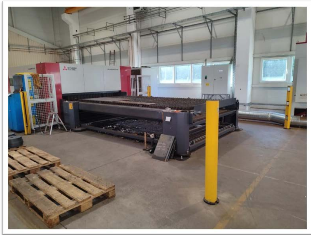
Fém megmunkáló üzemben munkatér védelemmel üzemeltetett lézervágógép
