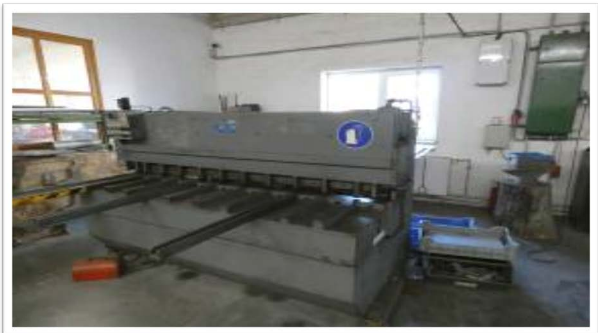
A gépi táblalemezollóról hiányzik a szerszám előtti védőburkolat. > Helyes gyakorlat: A védőburkolatot vissza kell szerelni!
