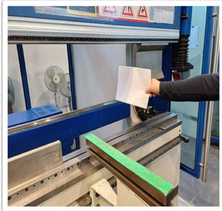
Élhajlító gép veszélyes terének védelme aktív optoelektronikus védőberendezéssel.
